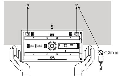
Percez aux endroits indiqués et utiliser des chevilles+vis, pour fixer le boîtier dans la position souhaitée.
